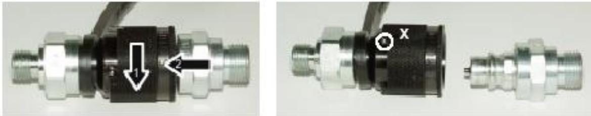
In der Stellung X Hülse zurückziehen - Muffe und Nippel werden getrennt - das Kuppeln mit dem Gerät erfolgt in umgekehrter Reihenfolge. Das Kuppeln der Geräte ist nur möglich, wenn die Schläuche **drucklos** sind. Zur Staubschutzsicherung werden die mitgelieferten Staubschutzkappen verwendet.
